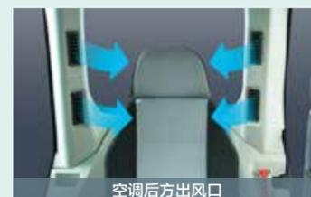
采用大容量空调，出风口设置在驾驶座右前方和左右后方柱上。冷暖风直接吹到操作者，保证舒适的作业环境。
