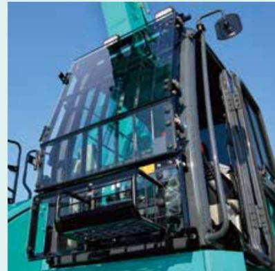
安装在防护栅格前面形成双重防护结构。
